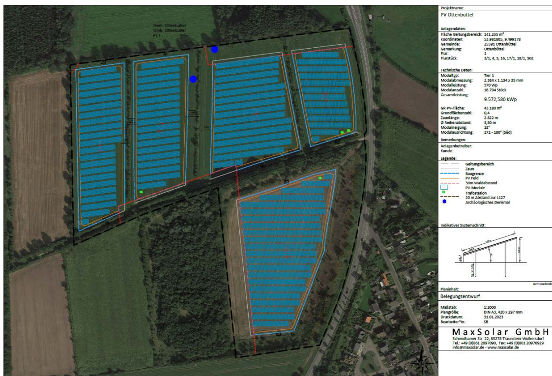
Abbildung 3: Belegungsentwurf des Solarparks Ottenbüttel (MaxSolar GmbH, Stand: 31.01.2023).
